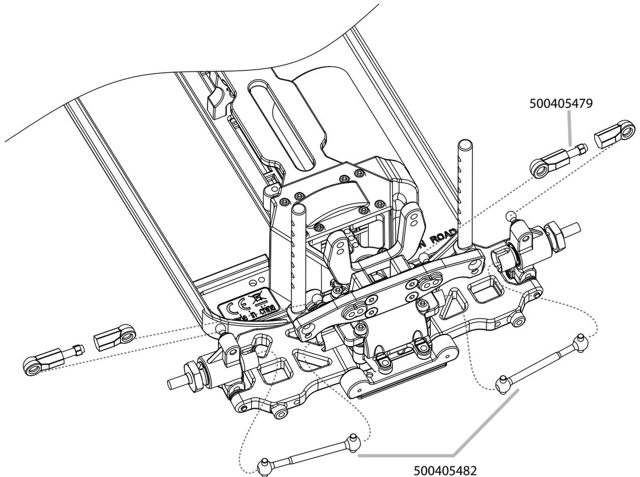
**18. Montage Stabilisatoren • Sway Bar Assembly**
