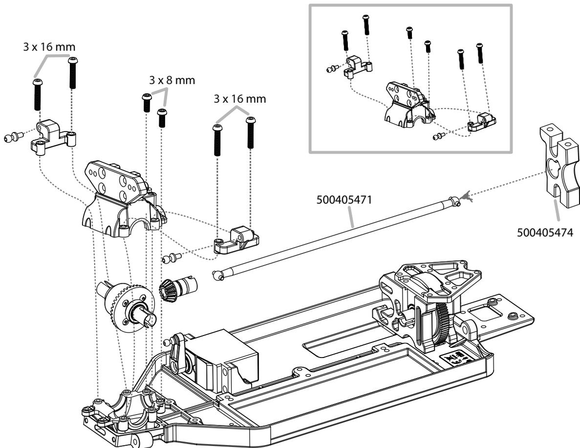
**9. Getriebebox • Gear Housing**
