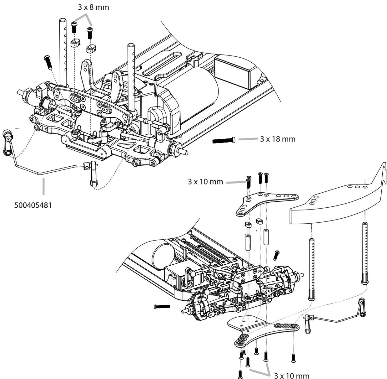
**19. Montage Stoßdämpfer • Shock Set Assembly**
