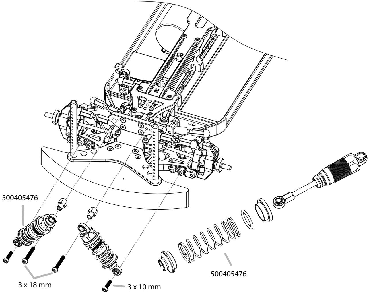
**20. Montage Stoßdämpfer • Shock Set Assembly**
