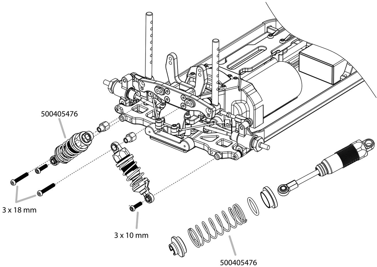
**21. Montage RC-System • Assembly RC System**
