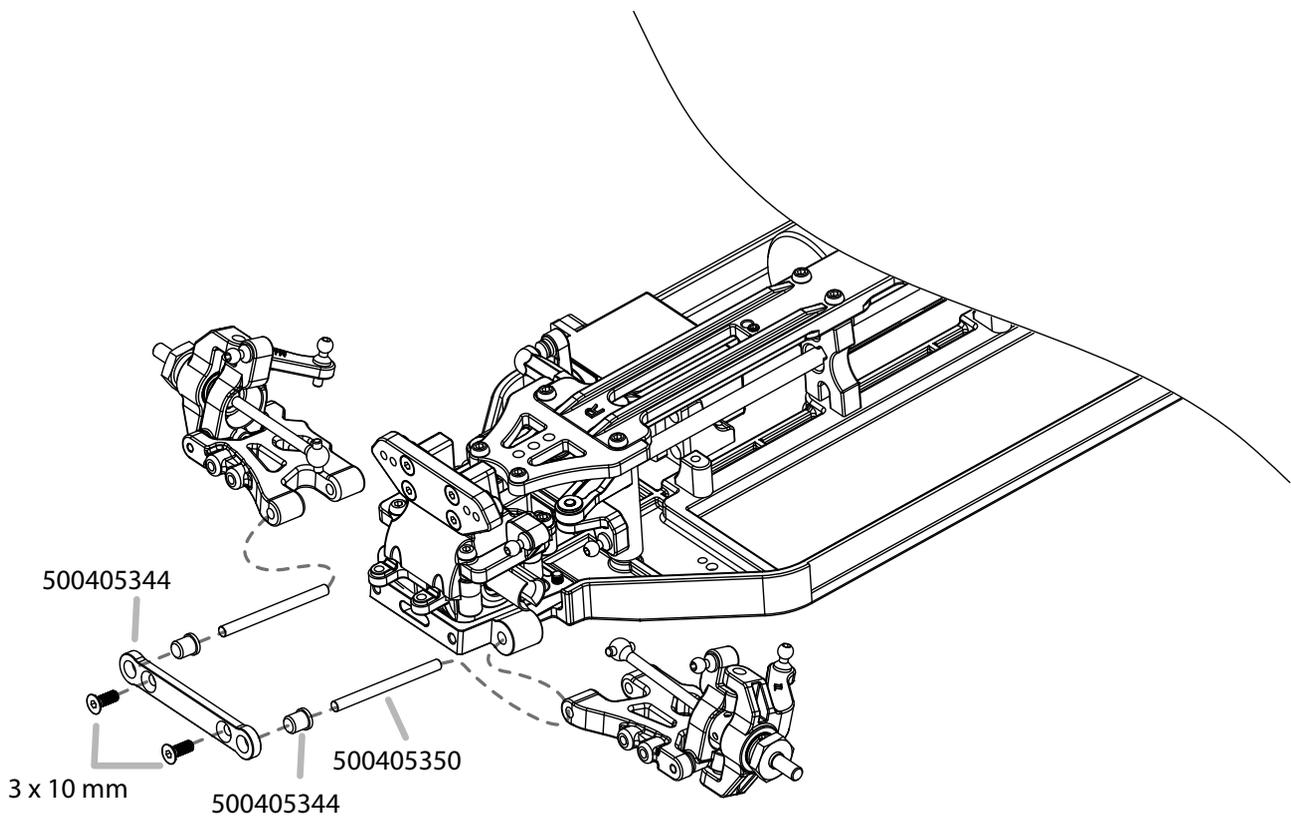
**15. Montage Gestänge • Turnbuckle Assembly**
